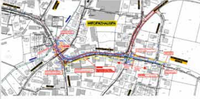
Ausbau der Dorfstraße in Wiedenzhausen mit Erneuerung der Oberflächenentwässerung
